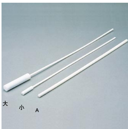
回転子取り出し棒(フッ素樹脂製) MAGNET
